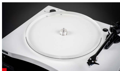
Akrylowy talerz o grubości 20 mm napędza cienką, słabo naciągniętą silikonową gumką.
